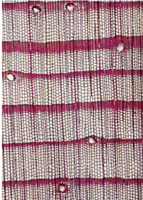
Abbildung 4: Kiefernholz, Querschnitt; Mikrobild im Maßstab 30:1 (Foto: D. Grosser)
